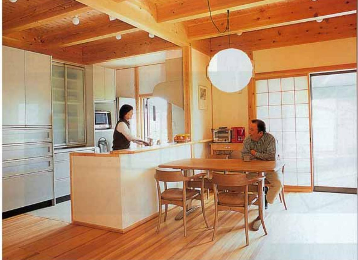
赤みの差し色が入ったラオス松の床板や土佐杉の構造材が、温かみのあるインテリアを構成しています。土佐杉は十分に人工乾燥されたもので、背割りをしていくなくても割れが起こりにくくなっています。壁には土佐和紙、ペアサッシの内側には障子がしつらえられ、断熱・気密性も万全。真冬も、ファンヒーターで一度暖めると熱が逃げにくく、快適に過ごせたそうです
